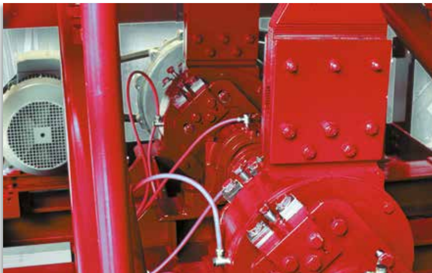
Эксцентрический привод и соединительная тяга
